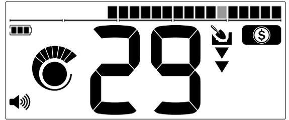
يظهر رقم تمييز الهدف عند اكتشاف أحد الأهداف. يوضح هذا المثال عملية اكتشاف ربع دولار أمريكي على عمق قليل. يومض القطاع الموافق لرقم التمييز فور الاكتشاف (يظهر باللون الرمادي).
